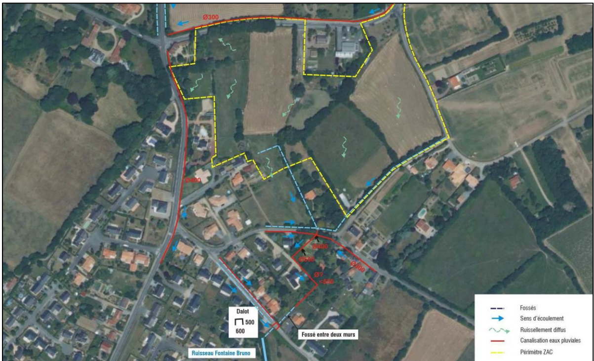
Cheminement des eaux pluviales sur le site de la Piletière
